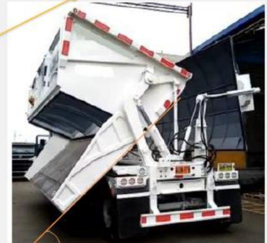
ANGULO DE DESCARGA , FACILITA LA DESCARGA RAPIDA Y 100% DE CONCENTRADO
