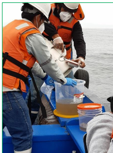
Figura 4.1. Utilización de la botella Niskin en el Punto P-13
