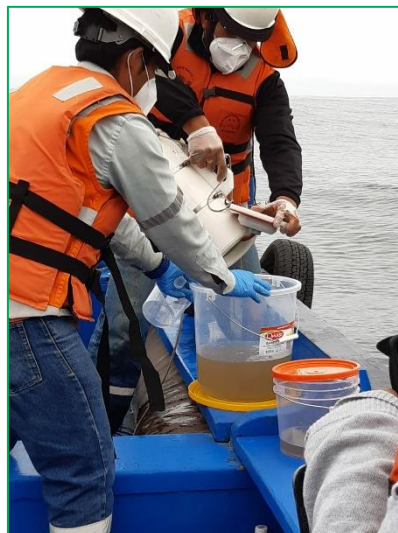
Figura 5.1. Utilización de la botella Niskin en el Punto P-13
